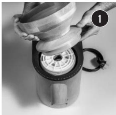
Vor dem Öffnen der Mockmill muss der Netzstecker gezogen sein. Drehen Sie den Trichter gegen den Uhrzeigersinn ab.
